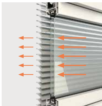
Protisluneční ochrany umístované v interiéru obvykle vpustí dovnitř teplo.
